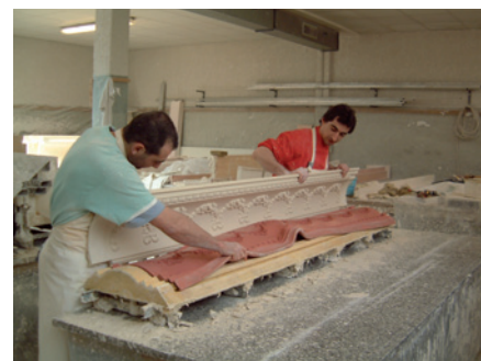
► 04 : Démoulage de la corniche.
