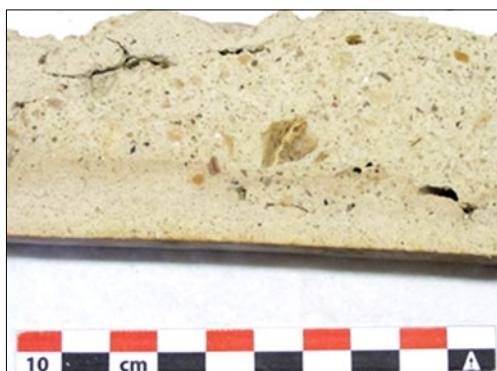
A gauche : composition des 79 échantillons d'enduits anciens analysés : en noir l'écart-type. A droite : la coupe de l'enduit de l'Hôtel Amelot de Bisseuil (Paris, 1660) semble révéler du sable : en réalité tous ces grains sont du gypse. (Crédits. Jean Ducasse-Lapeyrusse, LRMH, 2017)
