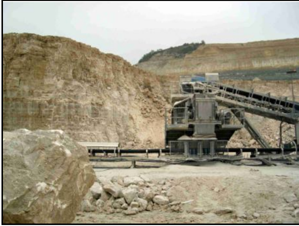
Extraction du gypse, le front de taille et le concasseur. Après abattage, le gypse est une première fois concassé en fond de carrière puis convoyé à l'usine par tapis roulant.
