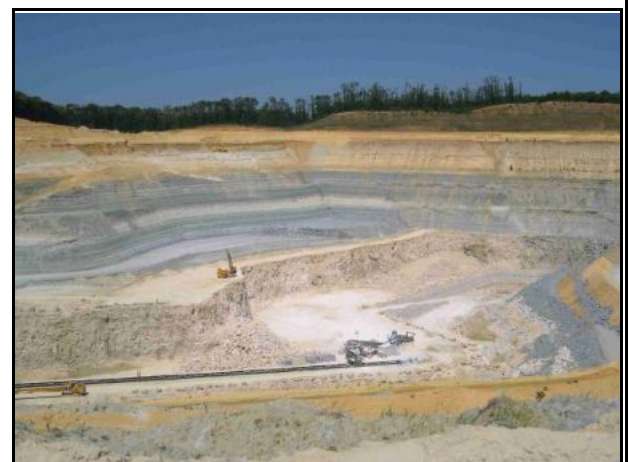
Vue actuelle de la carrière de Cormeilles-en-Parisis. Aujourd'hui seul le gypse est valorisé. Les découvertes sont déplacées et mises en remblai dans les zones déjà exploitées. Le front de taille, après s'être avancé vers le nord, s'est tourné vers l'ouest de la butte. Photo Musée du Plâtre, 2003.
