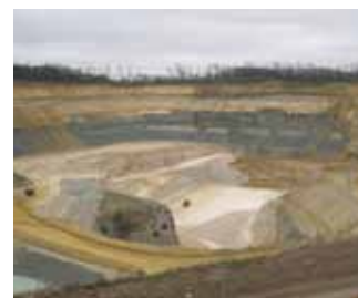
► Carrière à ciel ouvert de Cormeilles, vue d'ensemble de l'exploitation où pour découvrir le gypse toutes les couches de la butte sont retirées.
