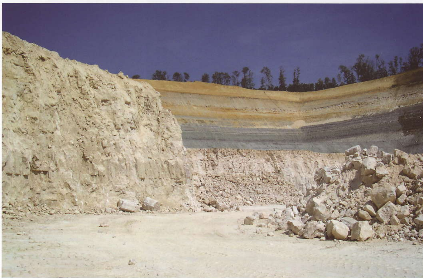
► Au cœur de la carrière de Cormeilles-en-Parisis, des blocs de gypse ont été abattus du front de taille.
