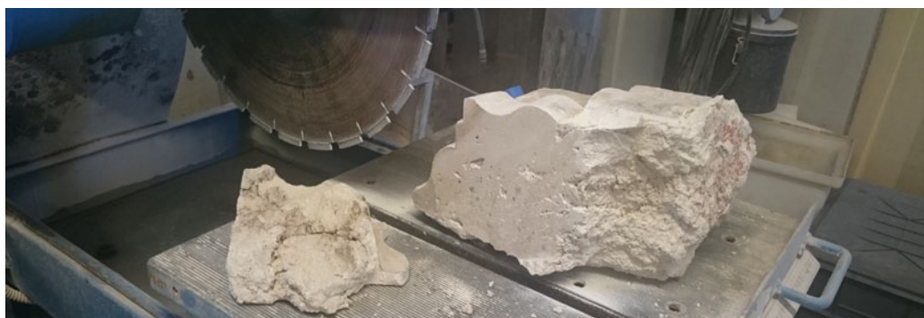
Coupe d'une corniche d'une maison de 1840 à Boissy-Saint-Léger (94). (Photographie Tiffanie Le Dantec)
